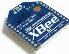
図 5 ZigBee 端末
