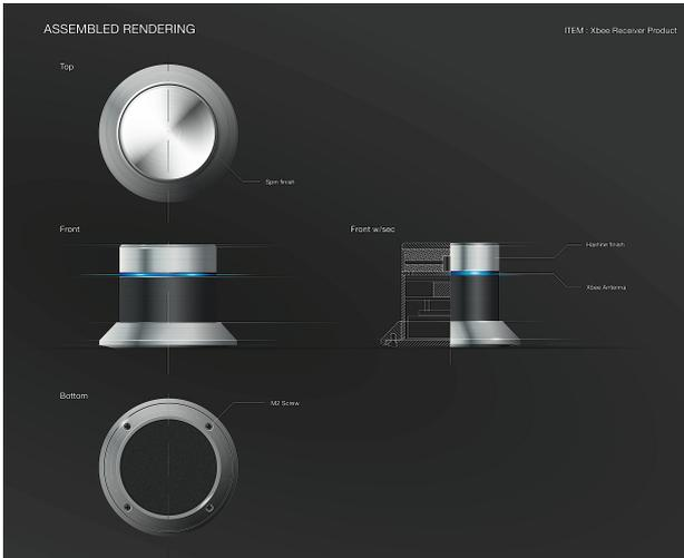
図 14 コントローラの三面レンダリング
