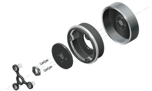
図 17 上部スイッチ部エクスプロージョン図
