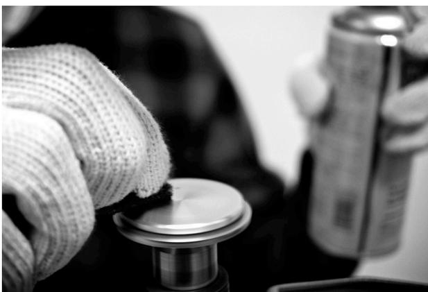
図 21 手仕上げによるスピン加工工程
