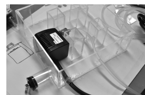
図 17 ポンプ挿入部
