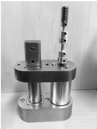
図13 組み立て後のモーターマウント
