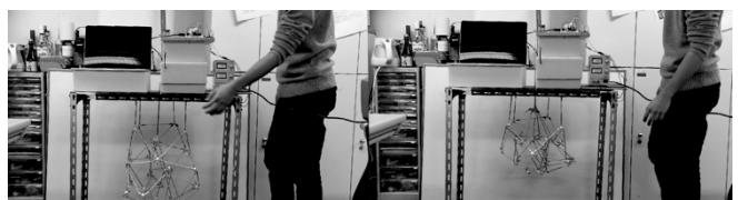
図 18 静電容量式タッチセンサが反応した時の反射反応
