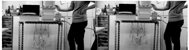
図 17 赤外線距離センサが反応した時の落ち着きのない運動
