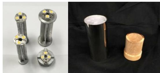
図 25 アルミニウムで作成したヒートシンク(左)及び点灯部の部材(右)
