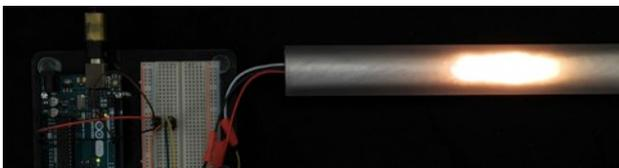
図 13 内部に粉雪和紙を仕込んだ外径 35mm のパイプ
