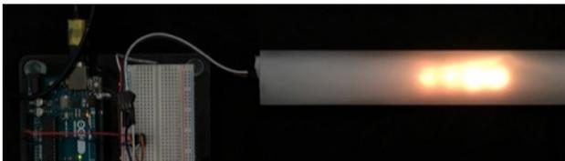
図 12 内部に提灯和紙を仕込んだ外径 40mm のパイプ
