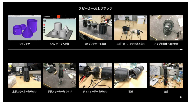
図 25 スピーカーユニット制作
